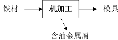
图4 模具生产工艺流程图
